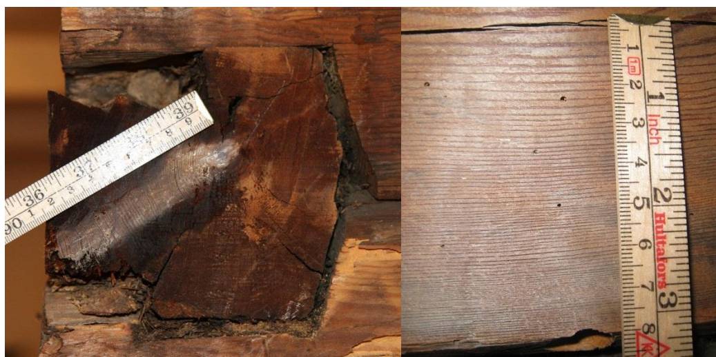
Figur 2: Præparation og billeder af stokkene i det gamle bryggerhus. Venstre ses tværsnittet og til højre det tangentielle snit. Tømmestokken er til senere kalibrering i analyseprogrammet.
