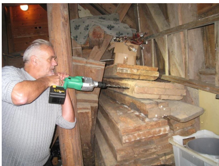
Figur 2: Boreprøver taget fra stavplanker fundet i tårnet i Vennesla kirke. (Foto: Claudia Baittinger)
