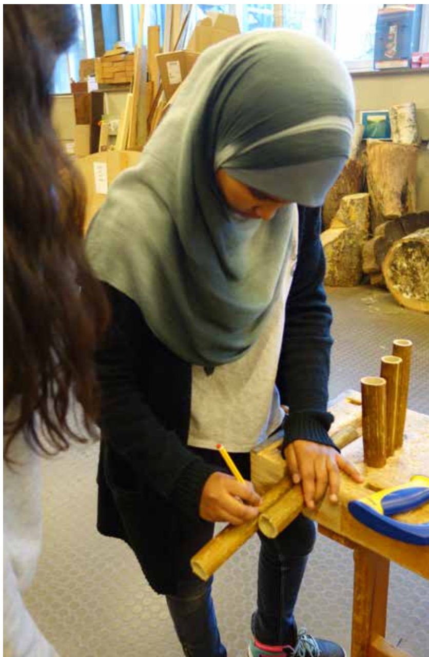
Venstre billede (2): Rørene måles af i den ønskede længde og saves af. Foto: Eva Fock
