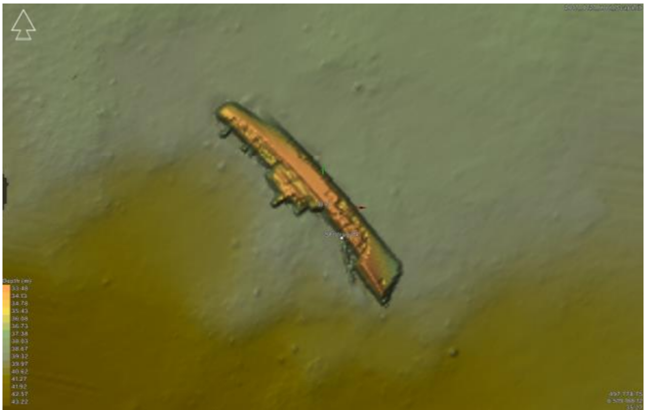
Scanningen på billedet viser det velbevarede vrage af den Engelsk trawler James Barrie , 666 BRT, sunket 1969 i indsejlingen til Scapa Flow nær Hoxa Head på 39 meters dybde. Alle besætningsmedlemmer blev reddet. Foto: Knud Jacobsen
