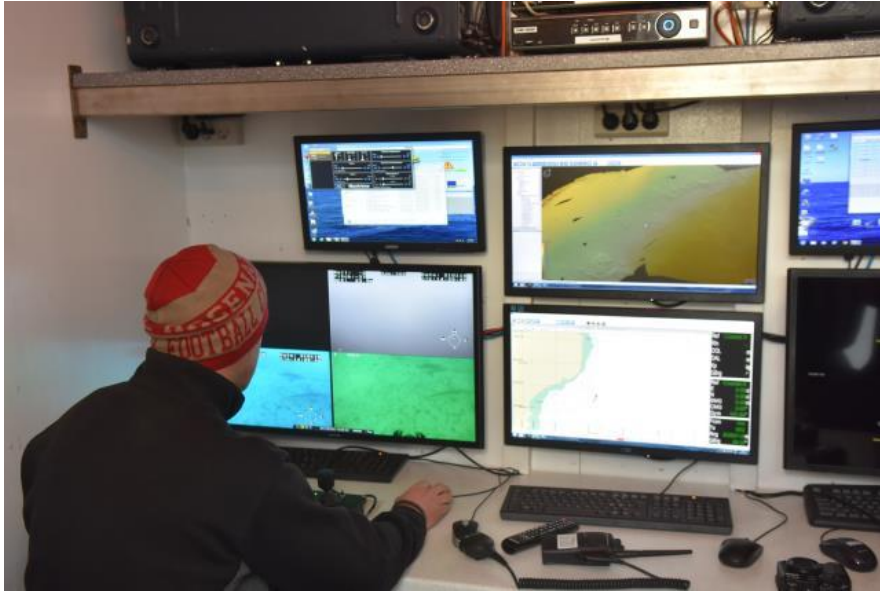
Kontrolcentret for ROV. Her kan man se i real time på videokamera, hvad der ligger på havbunden. Foto: Knud Jacobsen
