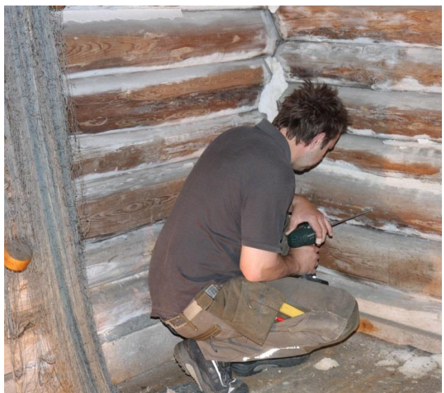
Figur 1: Boreprøver udtages fra tømmeræg, Boen gård.
