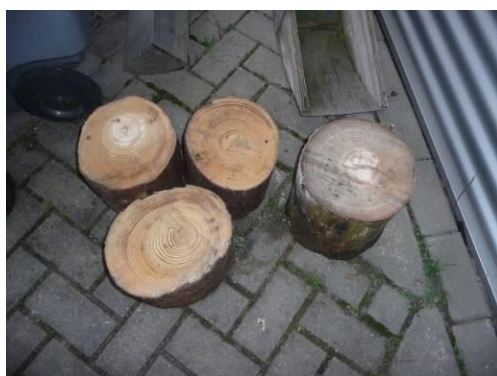
Fig. 6-9. Prøver fra fundament fra Kampen (Foto: Rene Klaassen).
