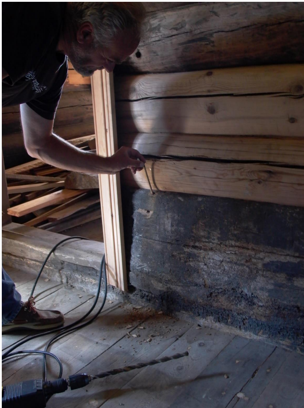
Udtagning af borekerne fra svill N0860t02 i væg mellem årestue og midtstue. Foto 2007.
