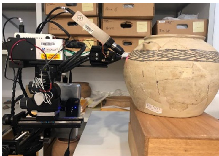
Spektroskopi (XRF-analyse) af bemaling på lerkar fra Hama. Foto: Emeline Pouyet
