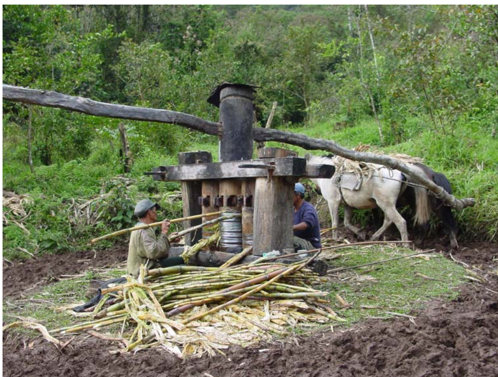
Fig. 2. Forarbejdning af sukker til sukkerrørsbrændevin. Mange af de nutidige sukkermøller har samme udformning som de første, der blev indført i 1500-tallet.
