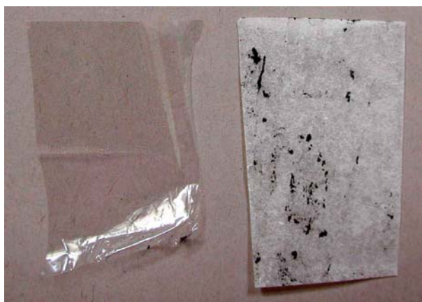
Fig. 2. Prøver af polyethylen (til venstre) og syre-fri papir (til højre) efter kunstig ældning i kontakt med bitumen
