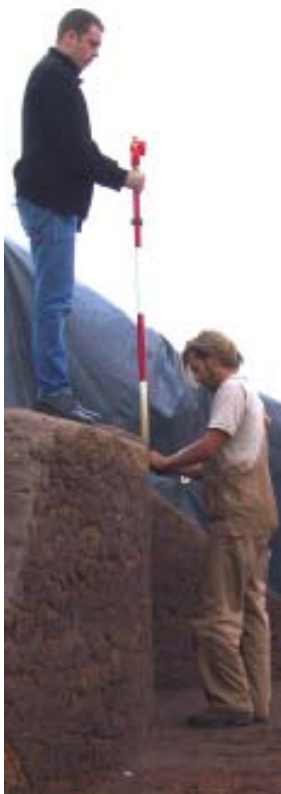
Fig. 2. Indmåling af søm med totalstation.
