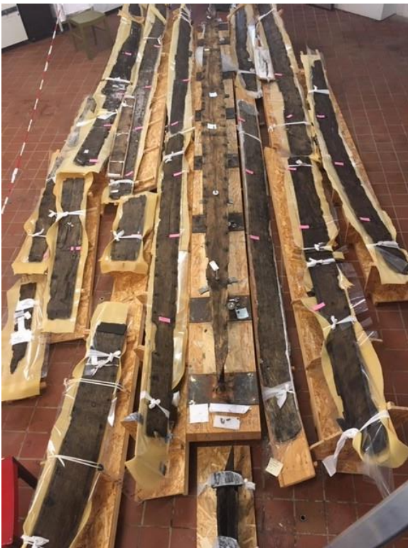
Figur 4) Plankerne, der stadig ligger på deres understøtninger fra frysetørringen, er her lagt op, så vi kan forestille os, hvilken rækkefølge de skal ligge i. Kølen ses lige i midten. Foto: Nationalmuseet, Anette Hjelm Petersen.
